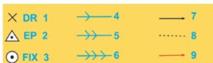
Рис. 50. Британская система обозначений на карте: 1. Счислимое место по линии курса относительно воды. 2. Счислимое место по линии пути (с учетом течения). 3. Обсервованное (определенное) место. 4. Путь относительно воды (кильватерный след). 5. Путь относительно грунта. 6. Течение. 7. Истинный курс. 8. Компасный курс. 9. Путь относительно грунта
