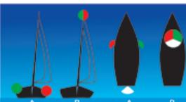
Парусное судно на ходу. Дальность бортовых - более 1 мили (2 мили для длины более 12 м). Лодки длиной до 20 могут иметь комбинированный фонарь на топе (B).
