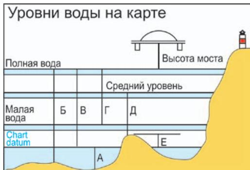
**Рис. 34.** Chart datum – уровень воды, обычно представляющий низший астрономический отлив. А – глубина нуля карты – char datum; В – общая глубина полной воды; С – высота прилива; D – разница уровней полной и малой воды; E – общая глубина; F – высота осушки
