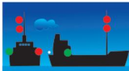
Судно до 50 м, лишенное возможности управляться, имеет ход относительно воды. Два красных круговых. Длина более 50 м - кормовой топовый.
