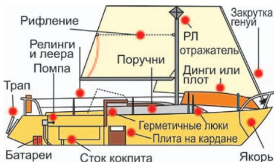
**Рис. 77. Средства безопасности на небольшом крейсере**
