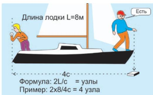
**Рис. 37. Измерение скорости яхты методом «голландского лага»**
