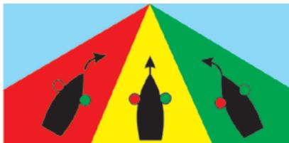
*Рис. 28. Цвет секторного маяка указывает положение судна относительно рекомендованного пути*
