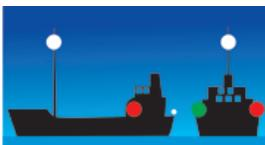
Судно длиной менее 12 м с механическим двигателем на ходу. Дальность топового огня - не менее 5 миль, Бортовых - не менее 2 мили.
