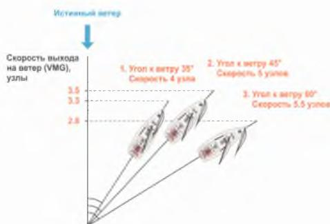
В первом случае яхта идет максимально остро, но скорость ее невелика. В третьем случае яхта идет максимально быстро, но не в ту сторону. Необходимый компромисс между скоростью и остротой хода, дающий максимальную скорость выхода на ветер, достигается во втором случае.
