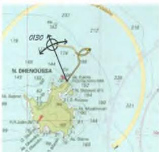
При построении мы сначала строим пеленг на маяк, а потом при помощи циркуля откладываем на пеленге полученную дистанцию. На карте линия позиции в виде дистанции обозначается как дуга со стрелками на концах.
